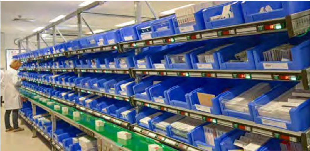
*Innerhalb von einer Stunde ordnet die neue, mit Fließband ausgestattete halbautomatische Kommissionieranlage 3.000 Artikel zu.*
